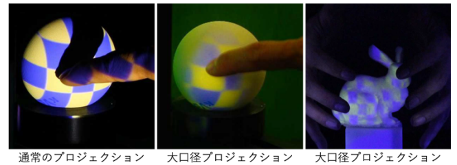
図5 透過型ミラー素子を大口径レンズとして用いた影の生じにくいプロジェクションマッピング技術 24)
